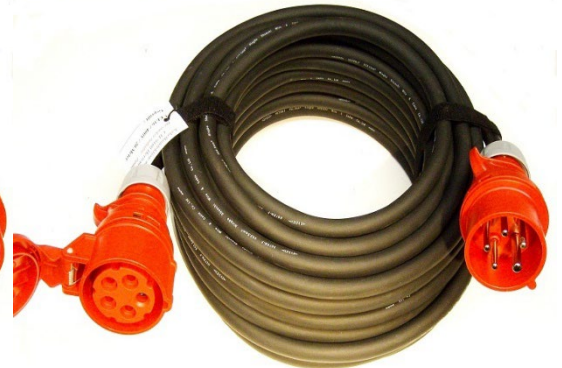
CEE32/5/400V/5x4mm2 oder 5x6mm2 Typ 77-1 = 5x4mm2 -15kW Typ 77-2 = 5x6mm2 -22kW
